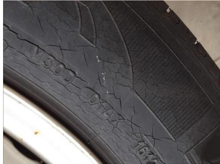
Figura 9 - Rachaduras nos flancos.
