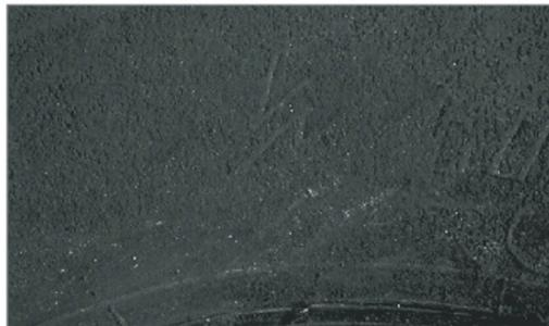
Figura 7 - Pneu que teve contato prolongado com derivados de petróleo.
