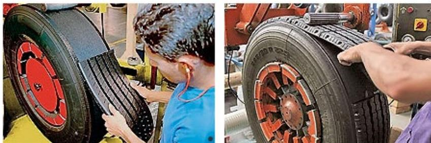
Figura 4 - Recapagem de pneu.
