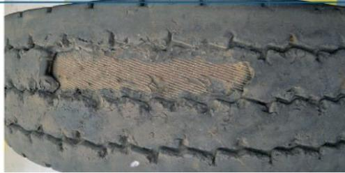
Figura 8 - Desagregação das lonas.
